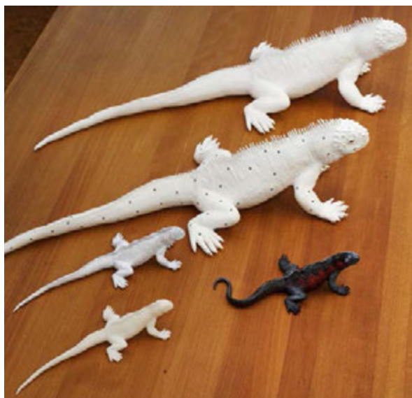
Afin d'illustrer la docilité proverbiale mais trompeuse des animaux des Galápagos, des iguanes marins sont produits en série au moyen d'un procédé laser sélectif. Mais un travail minutieux a été nécessaire pour obtenir à partir d'un animal en caoutchouc un prototype réaliste muni de tous les points nécessaires au scan en 3D.
